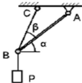
2. Груз весом  $P = 10 \text{ Н}$  подвешен на двух тросах AB и BC, составляющих с горизонтальной прямой углы  $\beta=15^\circ$  и  $\alpha=30^\circ$ . Определить усилия в тросах.
